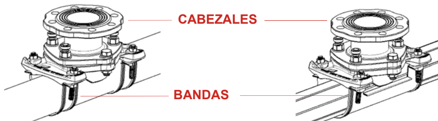
Montado sobre tubo de fundición
